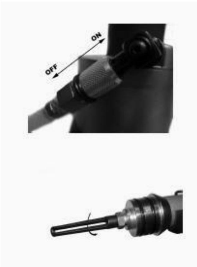
1. Conecte la Fuente de aire y ponga la válvula de desconexión/conexión en ON
